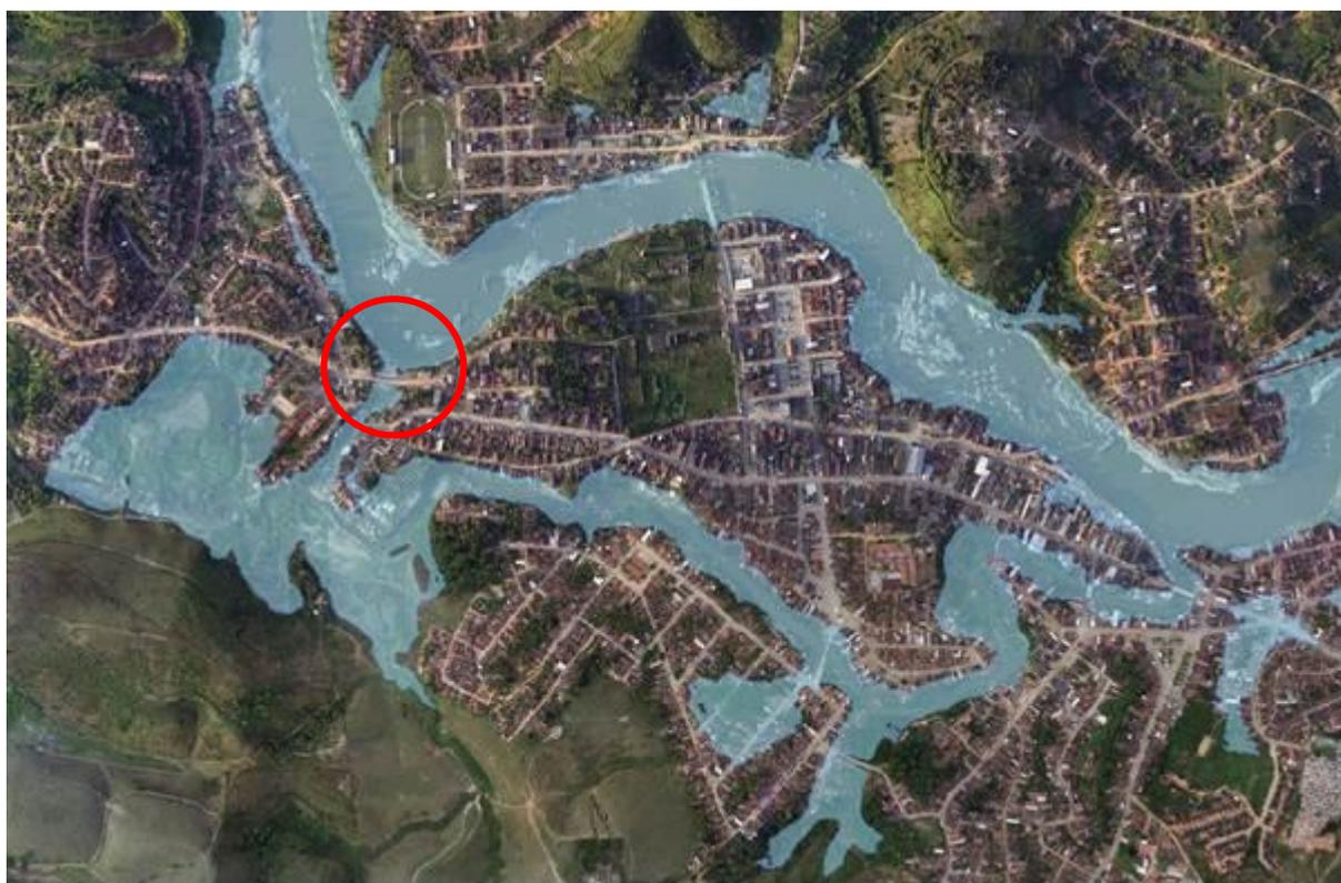
Figura 16 – Simulação da enchente de 2004 em Barreiros, com destaque para a invasão do rio Una na calha do rio Carimã.
