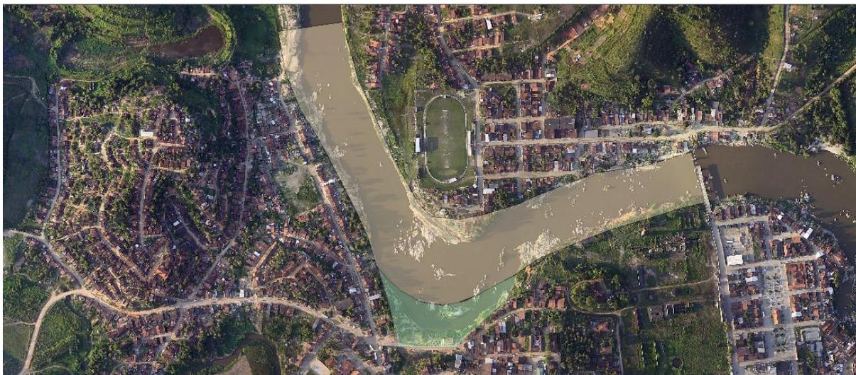
Figura 15 – Trecho objeto de intervenção em Barreiros: local onde o rio Una abriu caminho para invasão da calha do rio Carimã, ampliando a inundação na cidade.
