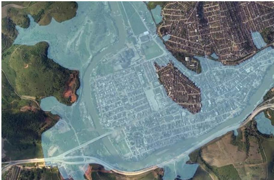
Figura 12 – Simulação da enchente de 2000 em Palmares: processo de inundação no trecho a ser objeto de intervenção.
