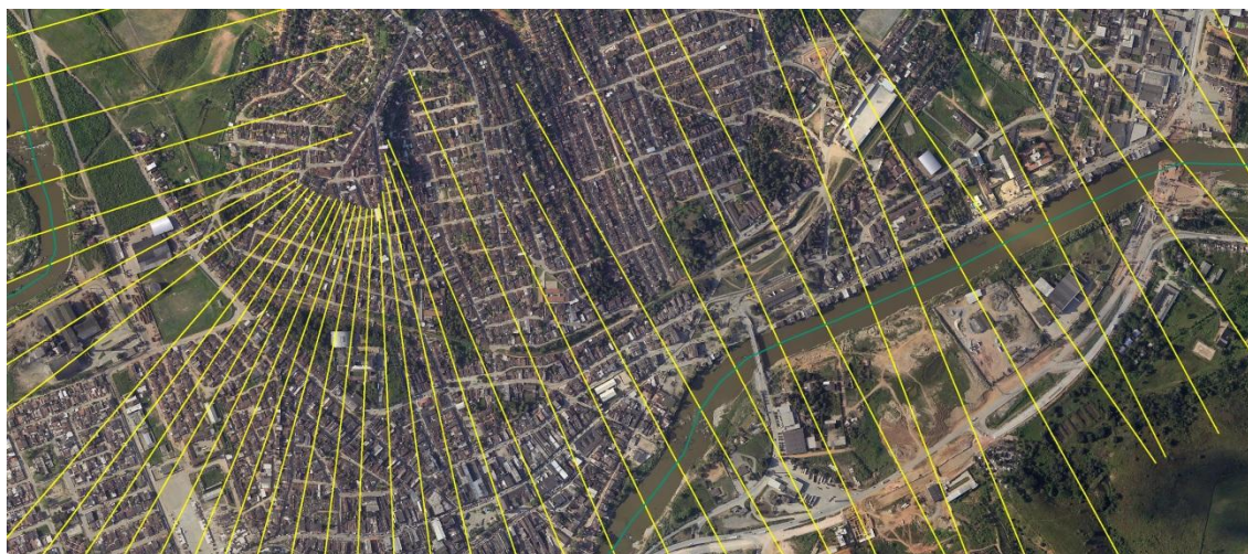
Figura 5 – seções transversais escolhidas no trecho urbano de Palmares para alimentar o modelo hidrodinâmico
