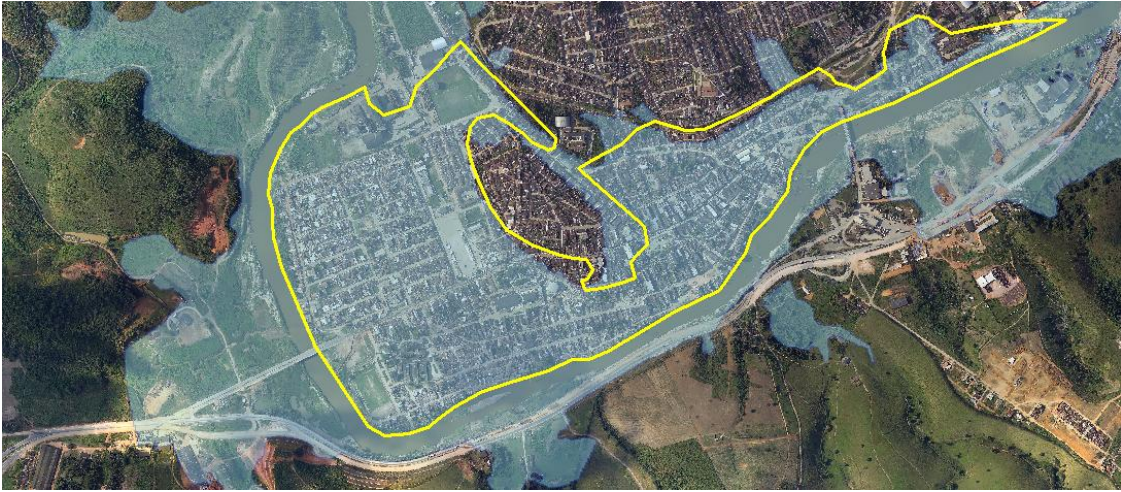
Figura 7 – Simulação da área inundada no evento de julho de 2000 e limites da inundação registrados no perímetro urbano da cidade de Palmares.
