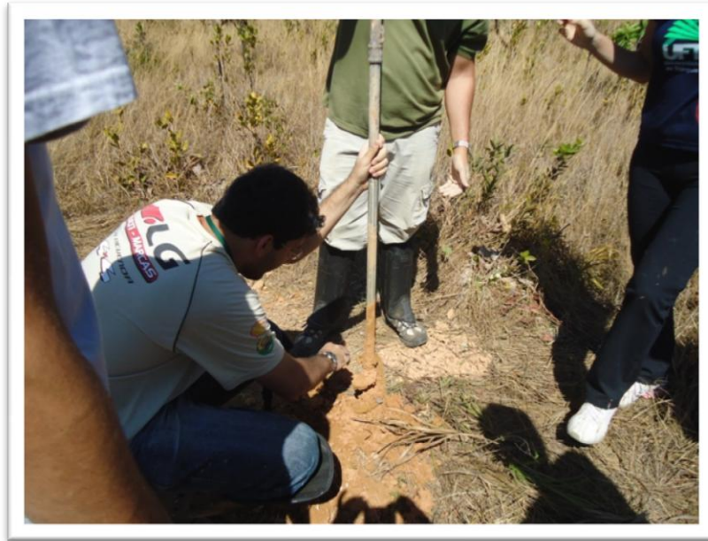
Figura 04. Bolsistas utilizando o trado para perfurar e posteriormente monitorar o N.A. Autor: DANTAS, A. R. 2010.
