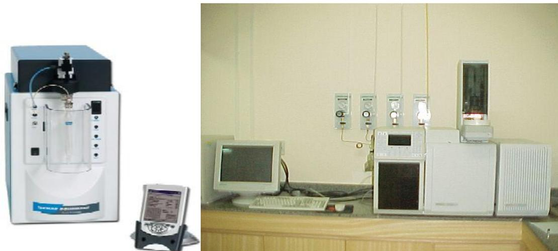
**Figura 2 - Fotografia mostrando o cromatógrafo gasoso acoplado ao sistema purge and trap com detectores pid-fid, para quantificação de BTEX**
