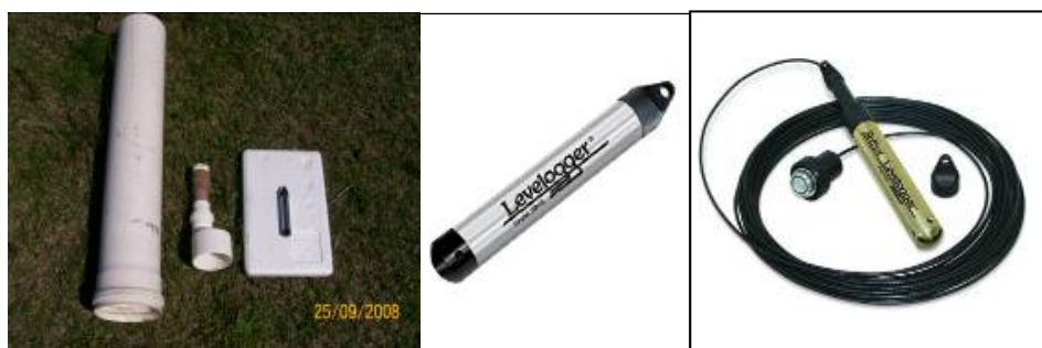
Figura 5 – Transdutor de pressão (sensor de nível, datalogger e bateria) utilizado. Fonte: Adaptado de AG SOLVE (2009)
