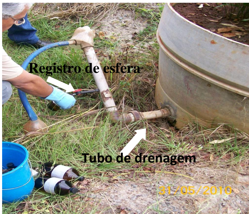
Figura 5 Detalhe da utilização do registro de esfera na coleta de amostra.
