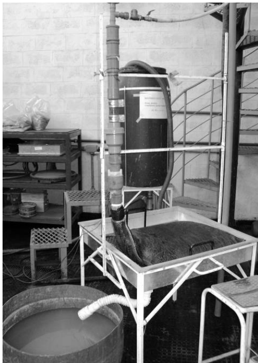
Figura 3. Equipamento ensaio de desaguamento em sistemas fechados por geotêxtil.
