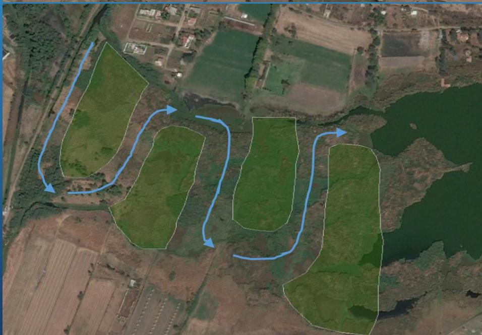
El Tule (*Typha* sp.) se ha demostrado que tiene una eficiencia de remoción de  $DBO_5$  de entre 85%, la DQO entre 55%, y que asociado con carrizo (*Phragmites australis*) puede llegar hasta un 90% y para el nitrógeno total puede llegar a tener remoción de 50 a 58%, incrementando sustancialmente la biomasa aérea y de raíces.
