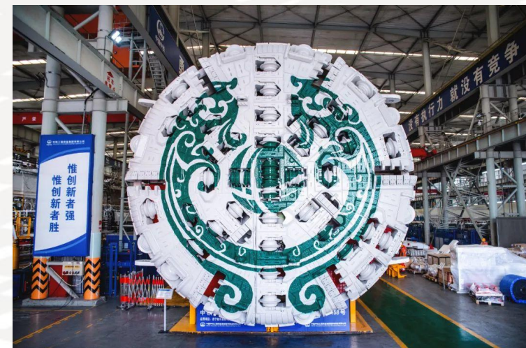
洛宁项目斜井TBM（直径7.2米） 生产下线
