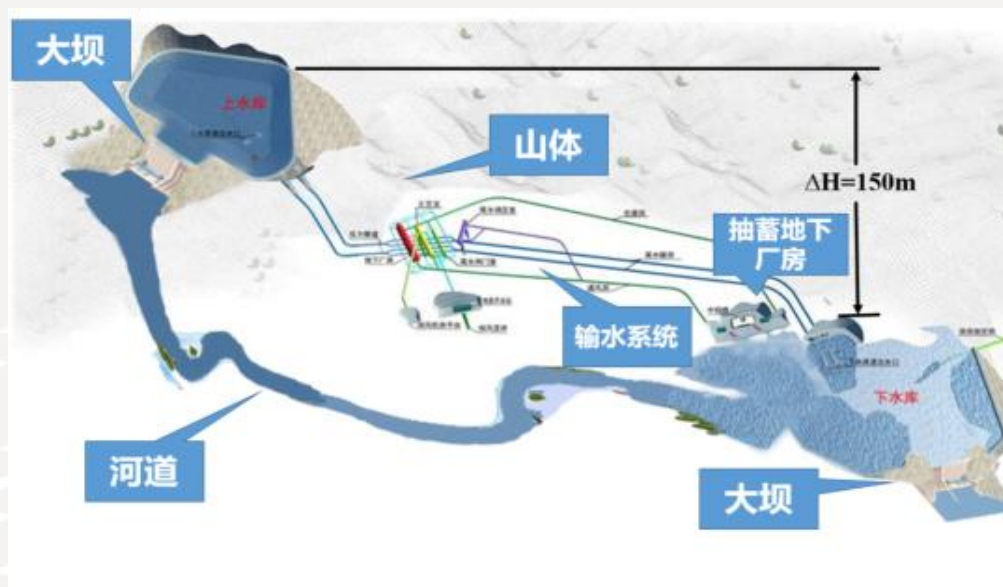
新建抽蓄输水系统及厂房布置示意图
