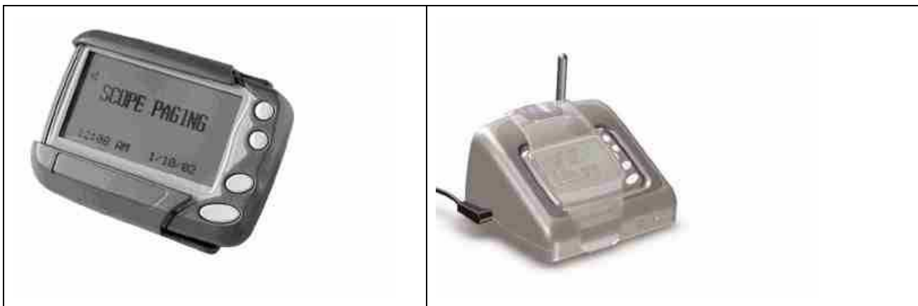
Figure 6 : Exemple de pager et sa base de recharge avec antenne réception (installé dans les mairies)
